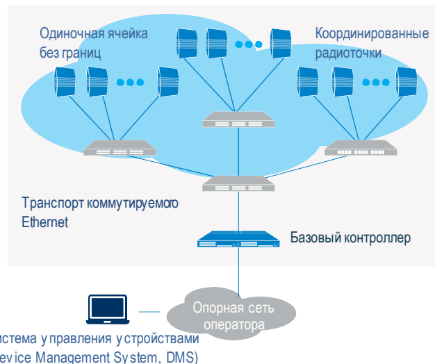
Рисунок 2: Инфраструктура DAS реализует конвергенцию с сетями передачи данных и использует сетевые кабели, а не дорогостоящие коаксиальные кабели.
